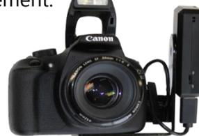
Une fois que le contrôleur et la caméra sont connectés et que le contrôleur est fixé à l'appareil photo, vous pouvez activer l'appareil photo (assurez-vous préalablement qu'une carte mémoire est insérée). Le contrôleur CamFi devrait s'être activé lors du démarrage du système, il est le premier appareil que vous devez activer tous les matins. Pour plus d'informations sur le contrôleur CamFi et ses paramètres, nous vous invitons à consulter CamFi "How to".
